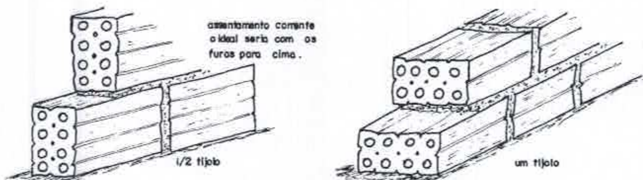
Figura 1 - Execução de alvenaria utilizando tijolos furados.
